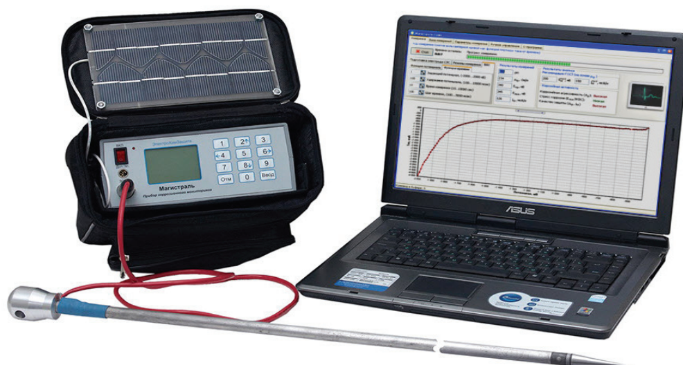
Рис. 4. Аппаратно-программный комплекс «Магистраль» для контроля образования коррозионных и стресс-коррозионных дефектов на внешней катоднозащищаемой поверхности магистральных трубопроводов в процессе их длительной эксплуатации
